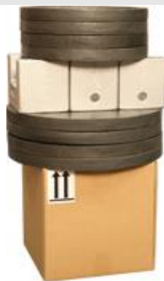
图 2 堆码试验示意图
