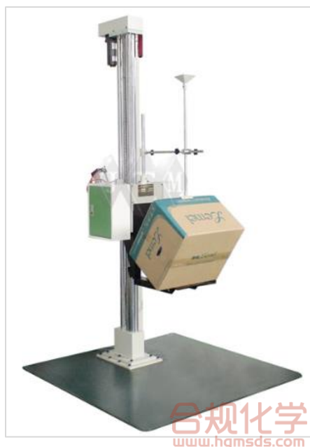
图3 跌落试验示意图
